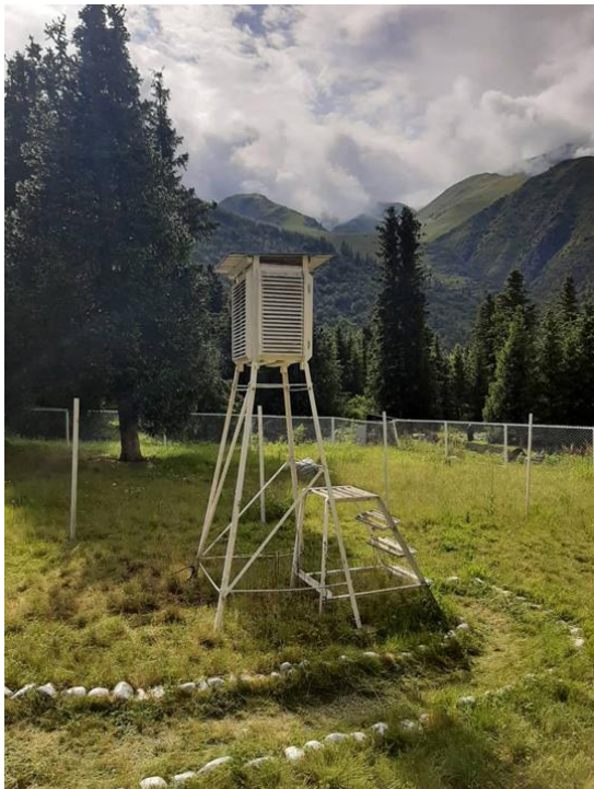
Психрометрическая будка МС Ала-Арча
