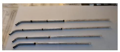
Почвенный бур - предназначен для взятия образцов талой и мерзлой почвы с нарушенной структурой для дальнейшего определения влажности и агрометеорологических свойств почвы; Мерзлотомер – предназначен для определения глубины промерзания и оттаивания почвы.
